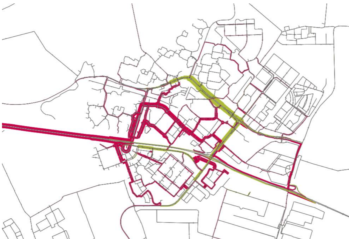
Figuur 6.3: te verwachten verkeersintensiteiten, verschil tussen onderzoeksalternatief 3 en de referentiesituatie. Hoe breder de lijn, hoe groter de verwachte toename.
