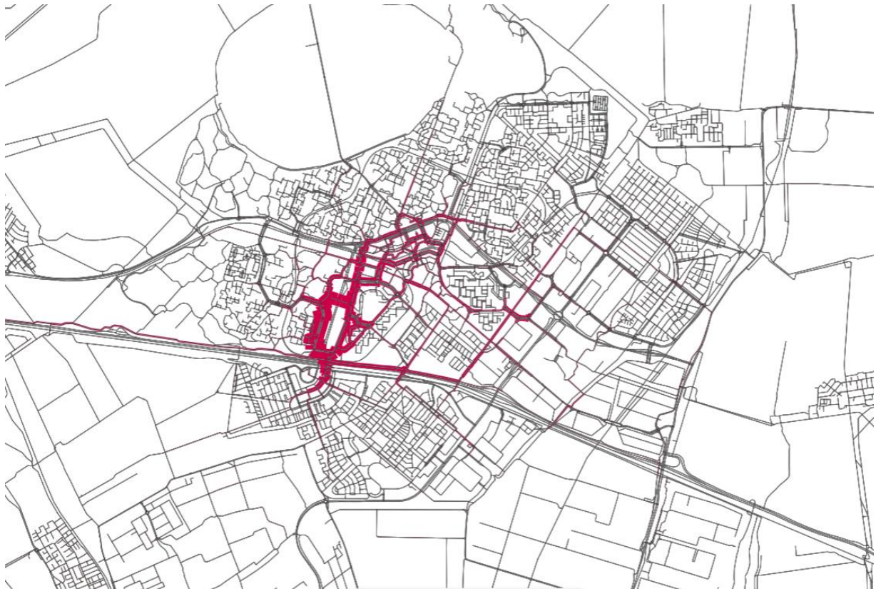
Figuur 6.4: Verwachte verschuivingen in het aantal fietsers, met in brede rode lijnen de grootste toenames. De lijnen corresponderen met de getallen in de tabel hierboven.
