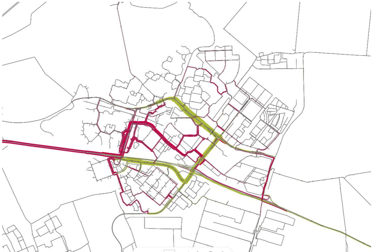
Figuur 6.2: Te verwachten verkeersintensiteiten, verschil tussen onderzoeksalternatief 2 en de referentiesituatie. Hoe breder de lijn, hoe groter de verwachte toename.
