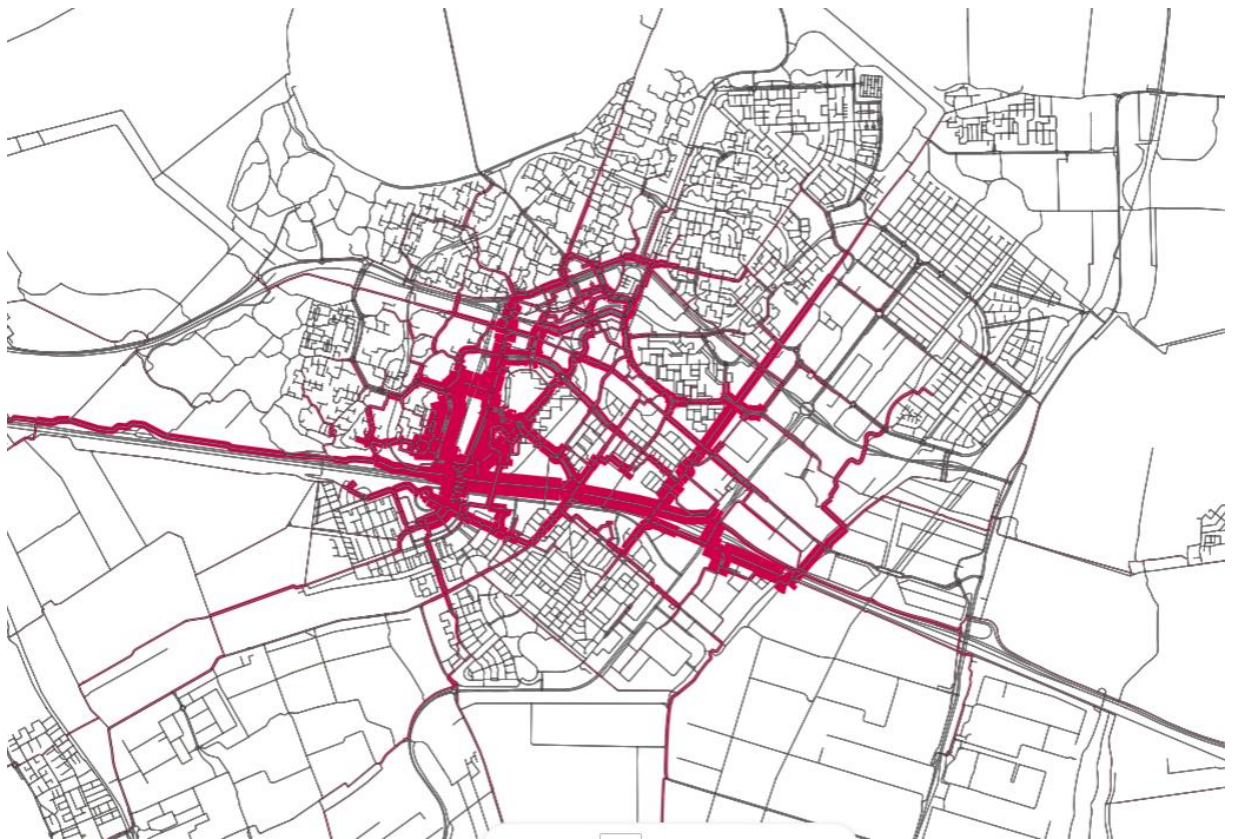
Figuur 6.6: Verwachte verschuivingen in het aantal fietsers, met in brede rode lijnen de grootste toenames. De lijnen corresponderen met de getallen in de tabel hierboven.
