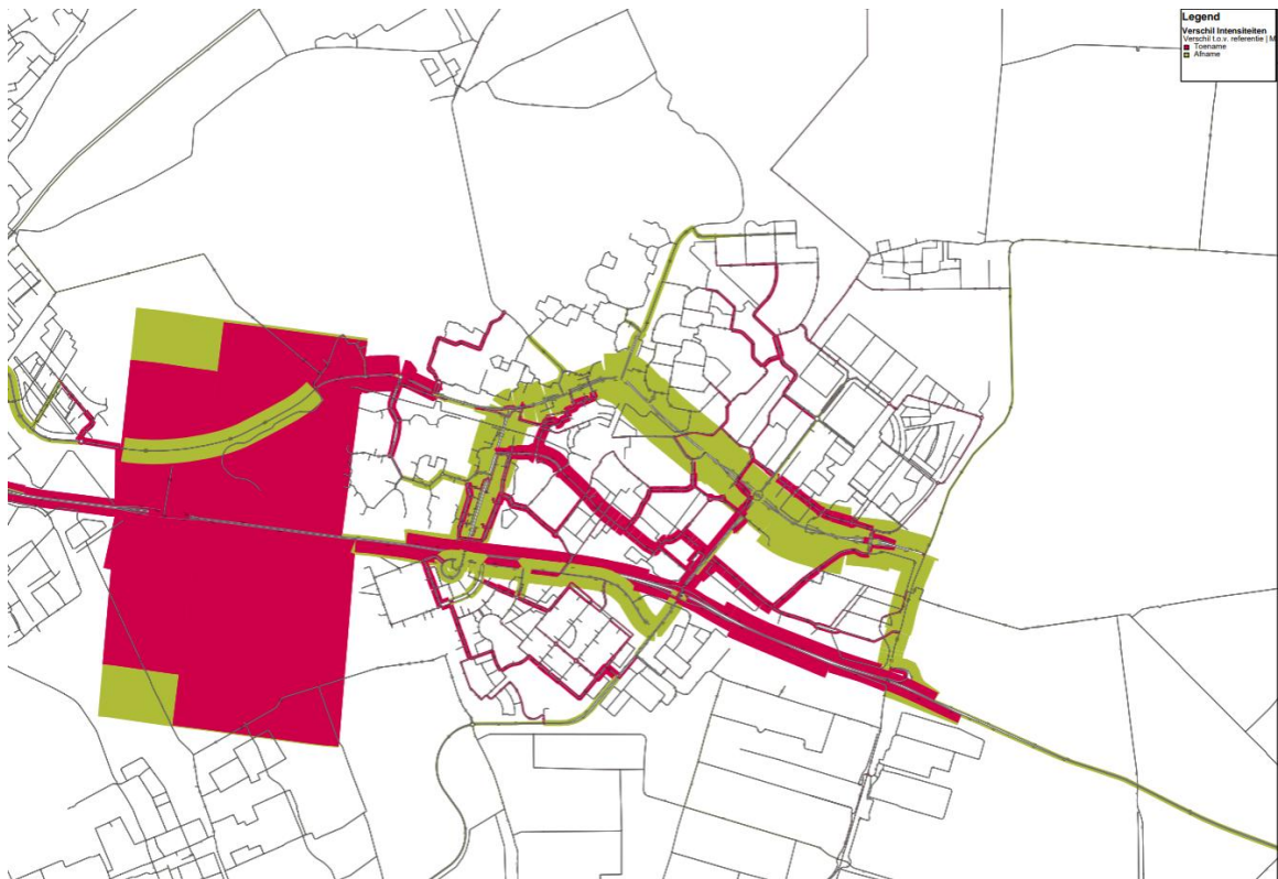
Figuur 6.1: te verwachten verkeersintensiteiten, verschil tussen onderzoeksalternatief 1 en de referentiesituatie. Hoe breder de lijn, hoe groter de verwachte toename. De grote toename aan de westzijde wordt verklaard door de aanwezigheid van de nieuwe ontsluiting, waar de relatieve toename erg groot is. Dit leidt niet tot een knelpuntsituatie.
